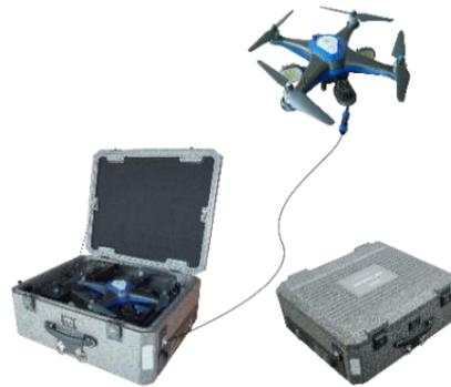
有線給電式照明ドローン
