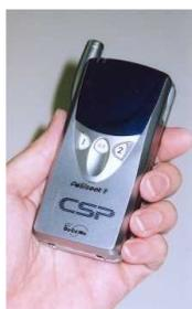
クルマのウインドガラスが破られたり、ドアやトランクがこじ開けられたとき、その衝撃をキャッチしたカーセキュリティ(センサー)からの信号を、クルマの持ち主の携帯電話・パソコンにメールで知らせるモバイルガード端末
