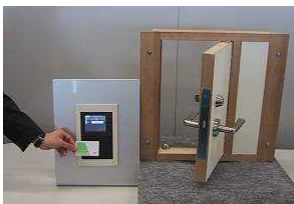
「Suica」を利用したビル入退館システムの デモンストレーション
